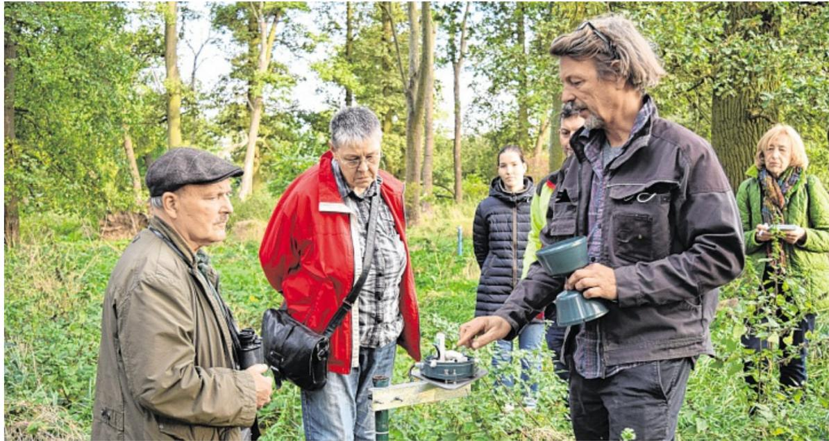
Volker Kleinschmidt (r.) demonstriert die Funktionsweise eines Regensammlers, über den sich die Niederschlagsmenge an der Messstation nachvollziehen lässt.
