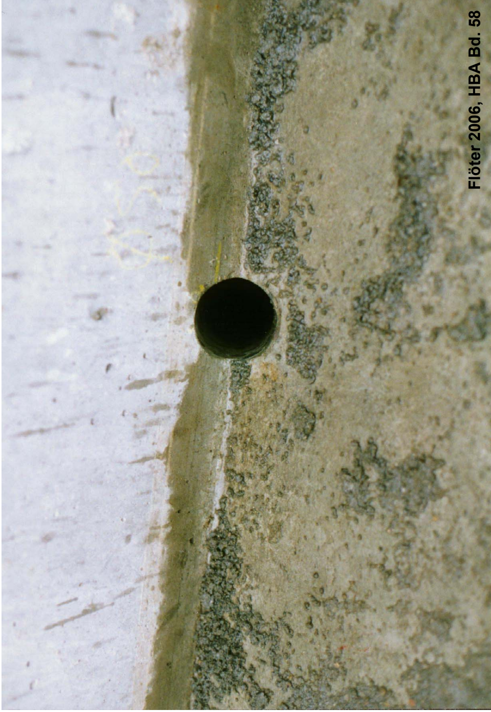
Foto 6: Lysimeteranlage Bullerdeich in Hamburg-Hammerbrook: Detailaufnahme Abflussöffnung im Lysimeterbehälter ohne eingesetztes Kunststoffrohr (Aufnahmedatum 03.07.1996)
