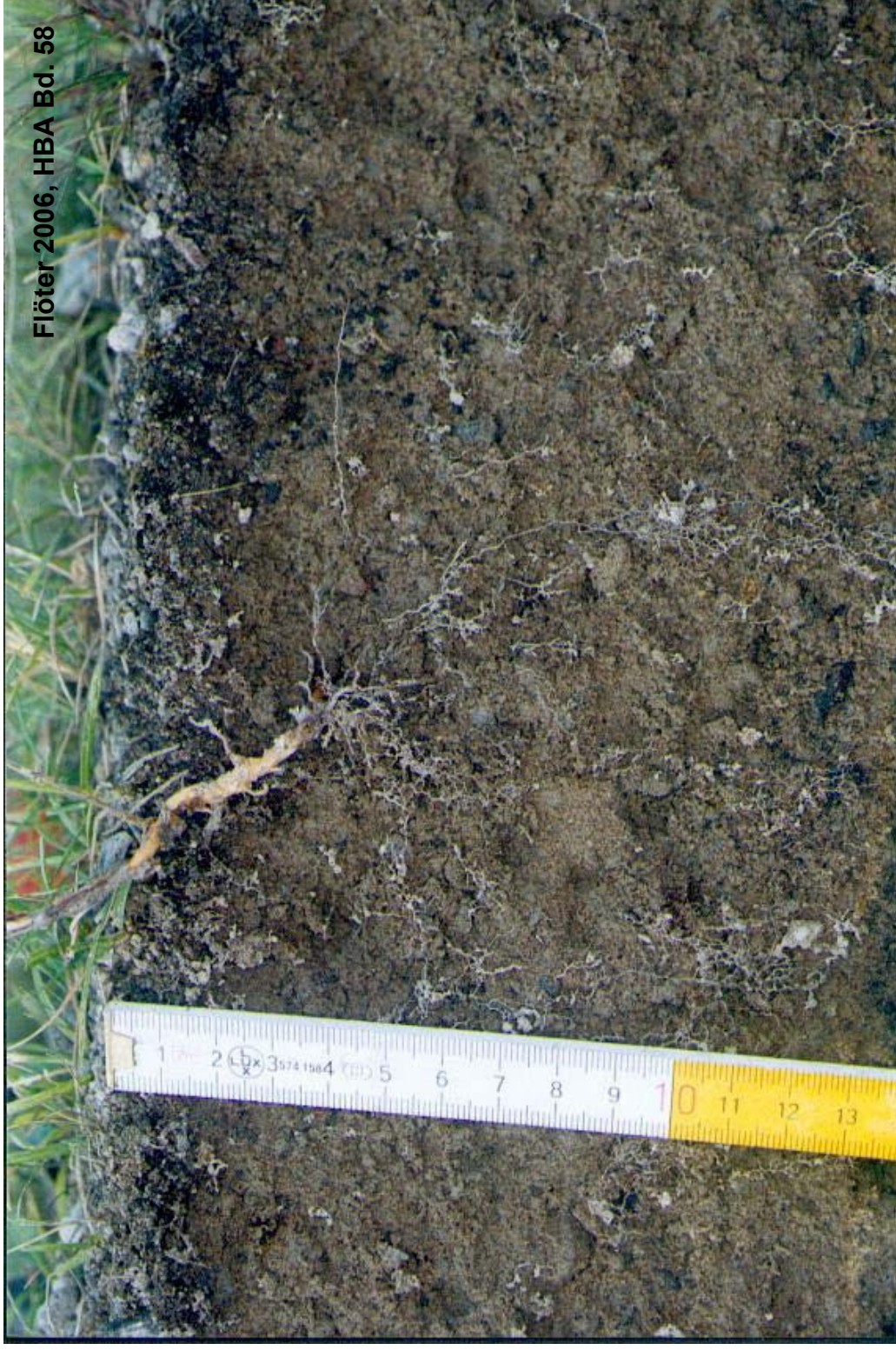
Foto 7: Testfeld 2 - Deckschicht aus Glensanda. Lysimeteranlage Bullerdeich. Detailaufnahme des sehr stark durchwurzelten und humosen Glensandas (Aufnahmedatum 12.07.00 )
