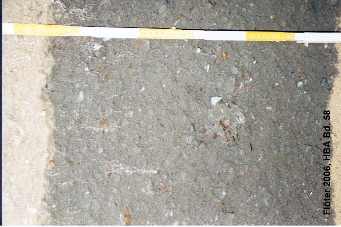
Foto 15: Testfeld 2 - Deckschicht aus Glensanda. Lysimeteranlage Bullerdeich. Durchwurzelung der HMV-Asche bis zu einer Tiefe von 0,35 m u. OK. Die eisenhaltigen Bestandteile oxidierten (Aufnahmedatum 12.07.00)
