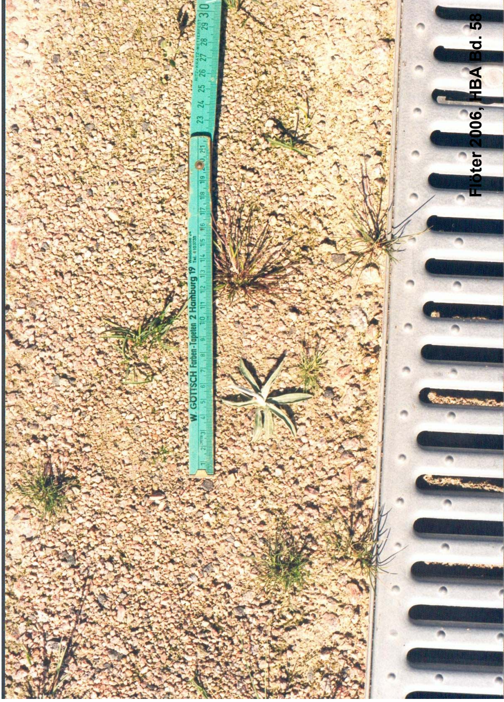
Foto 4: Testfeld 2 - Deckschicht aus Glensanda. Lysimeteranlage Bullerdeich. Die Deckschicht ist 9 Monate nach der Herstellung spärlich mit Pflanzen bewachsen (Aufnahmedatum Juni 1997)
