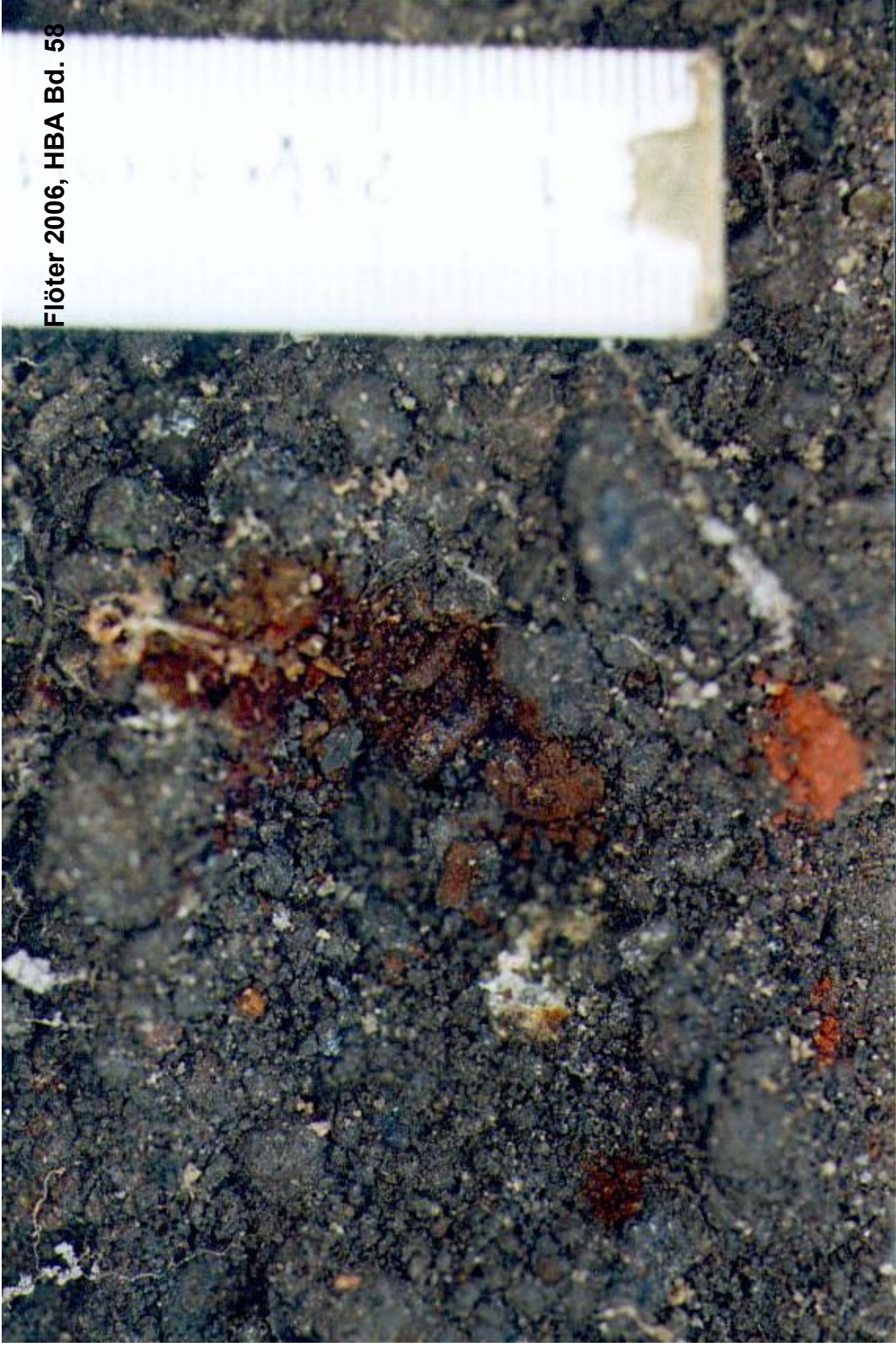
Foto 17: HMV-Asche. Lysimeteranlage Bullerdeich. Oxidation von eisenhaltigen Bestandteilen der HMV-Asche 0/32 mm (Aufnahmedatum 12.07.00)
