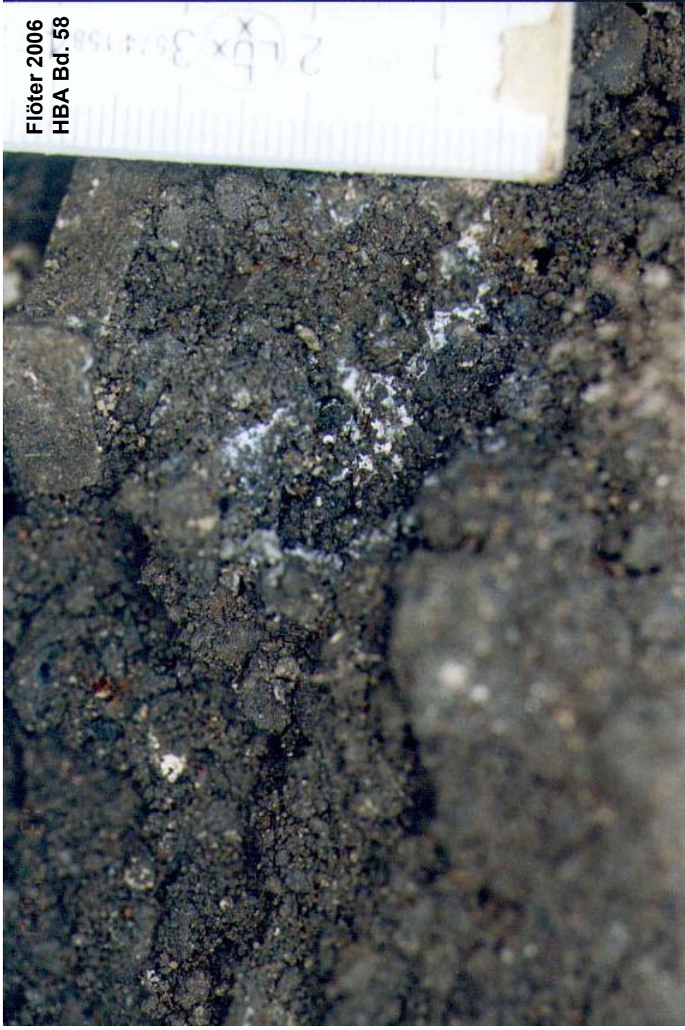
Foto 18: HMV-Asche. Lysimeteranlage Bullerdeich. Weiße Ausfällungen (Salze) auf den Kornoberflächen der HMV-Asche 0/32 mm (Aufnahmedatum 12.07.00)
