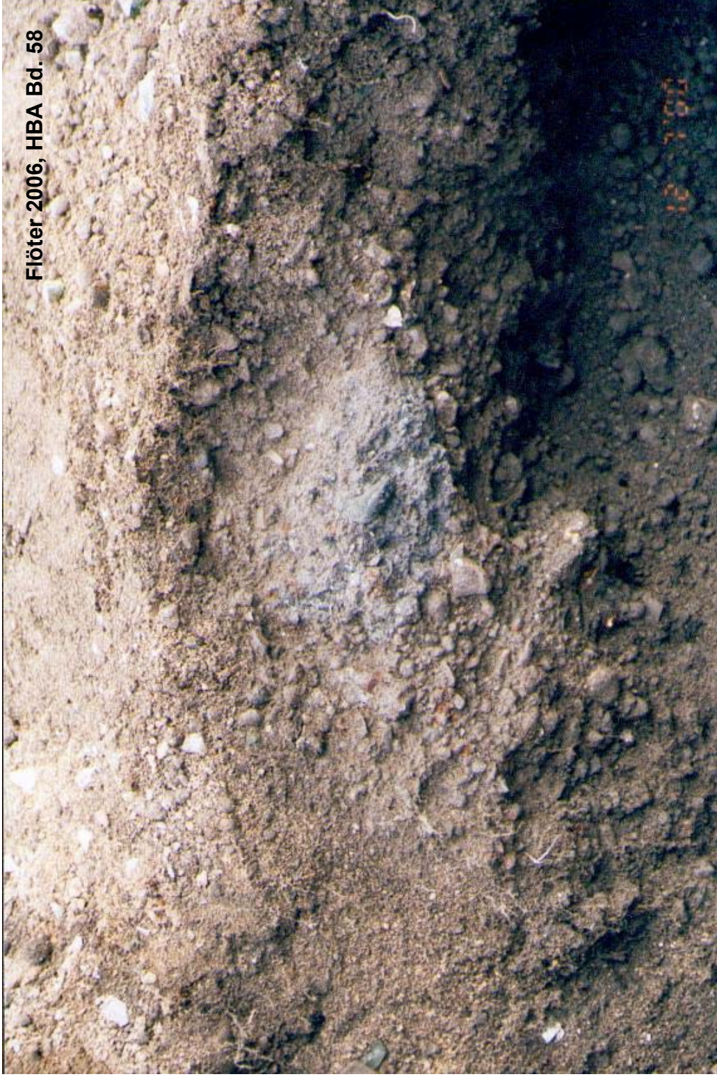
Foto 19: HMV-Asche. Lysimeteranlage Bullerdeich. Weiße Ausfällungen (Salze), die Bereiche der HMV-Asche 0/32 mm in elliptische Form verkitten (Größe eines Footballs, Aufnahme datum 12.07.00)
