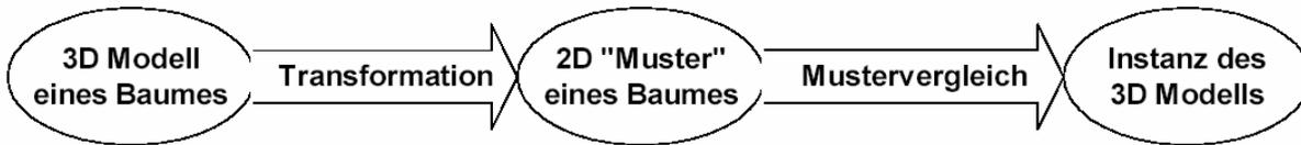
**Abb. 3.1: Modellgetriebener Ansatz zur Baumextraktion nach STRAUB (2003A, S. 28)**
