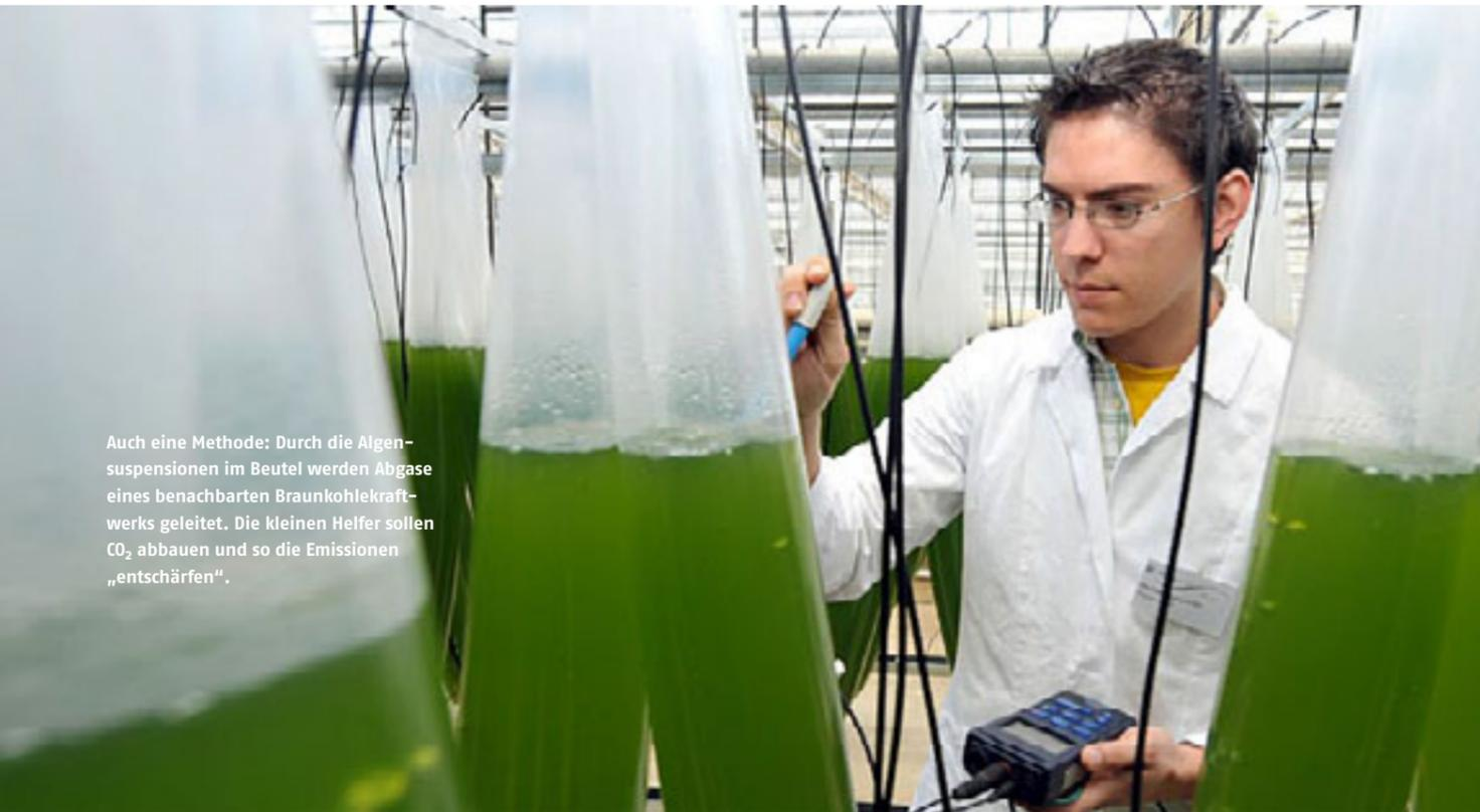
Auch eine Methode: Durch die Algen-suspensionen im Beutel werden Abgase eines benachbarten Braunkohlekraftwerks geleitet. Die Kleinen Helfer sollen CO<sub>2</sub> abbauen und so die Emissionen „entschärfen“.
