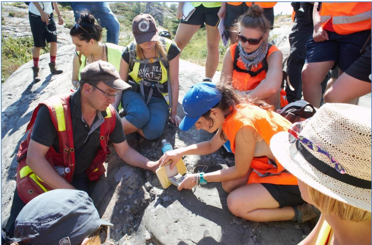
*Erläuterung von Professor Riller zum Gebrauch des Geologenkompasses an Gesteinsoberflächen, die durch Gletscher geformt wurden. Das Feldbuch dient als Verlängerung einer geneigten Schichtoberfläche, um eine Messung zu ermöglichen.*
